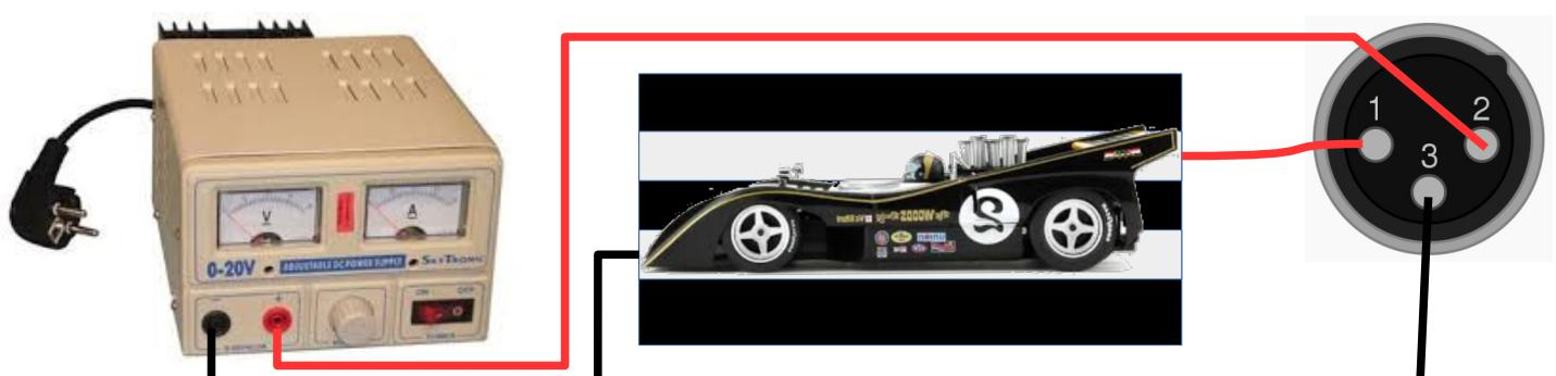
Note : en cas de comptage par le rail (zone de coupure), il est nécessaire d'inverser le sens d'alimentation de cette zone de coupure par rapport au sens d'alimentation de la piste.
