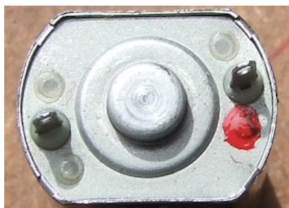
En général une marque rouge est présente à l'une des patte du moteur
